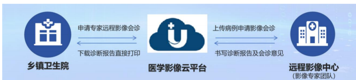
图 1 远程影像服务业务流程图
